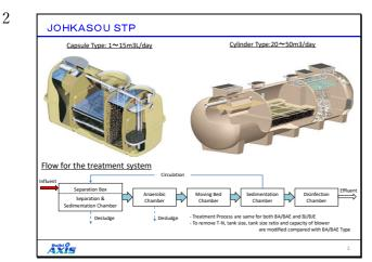
浄化槽のカタチは2タイプあります。 水量が少ない向けのカプセルタイプ と大水量の円筒タイプがあります。さ らに水量が多い場合、円筒タイプを 複数本並べて対応します。
